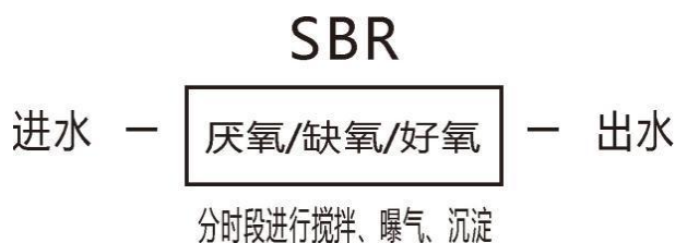
图 2-2 SBR 法尾水处理系统流程图
