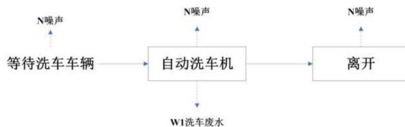
图 2-7 车辆清洗工艺流程及产污节点图
