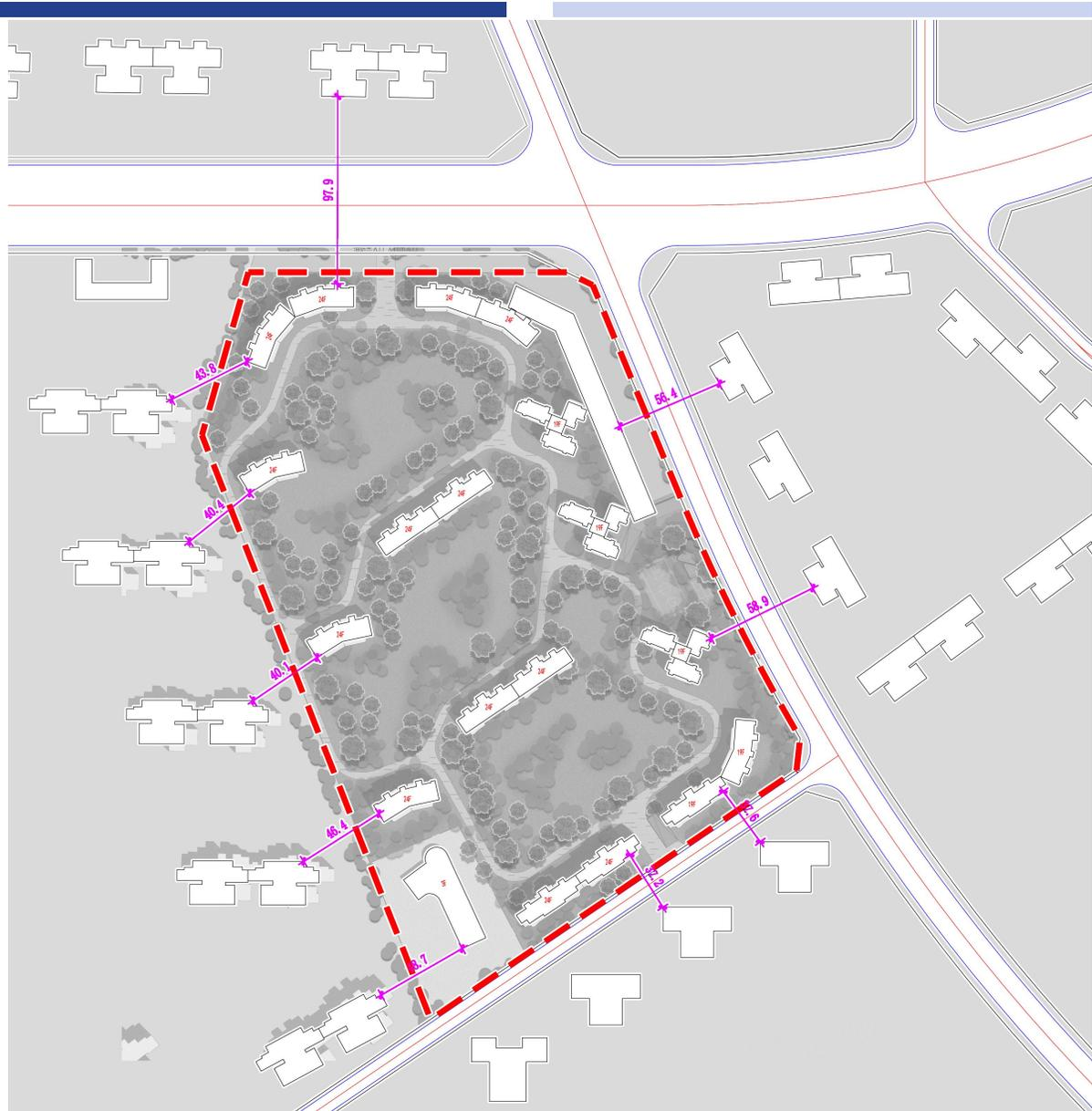
**综上，规划修改后总平面方案能够满足建筑间距要求，影响较小，基本可控。**
