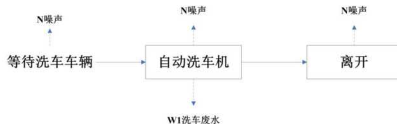
图 2-7 车辆清洗工艺流程及产污节点图
